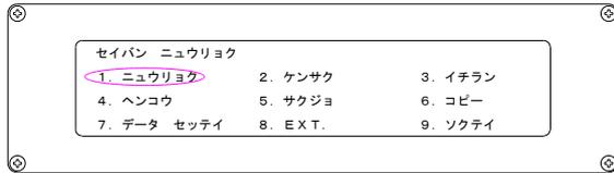
★キーボードの1を押しカーソルを1. ニュウリョクに移動させ、ENT（選択）を押します。
