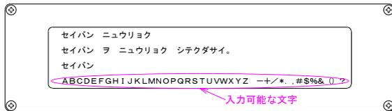
★アルファベットや記号はキーボードの←→で移動させてENTを押して選択します。数字はテンキーを押します。入力を終わりましたらSET（決定）を押します。間違えた場合はCLRを押して最初から入力し直して下さい。
